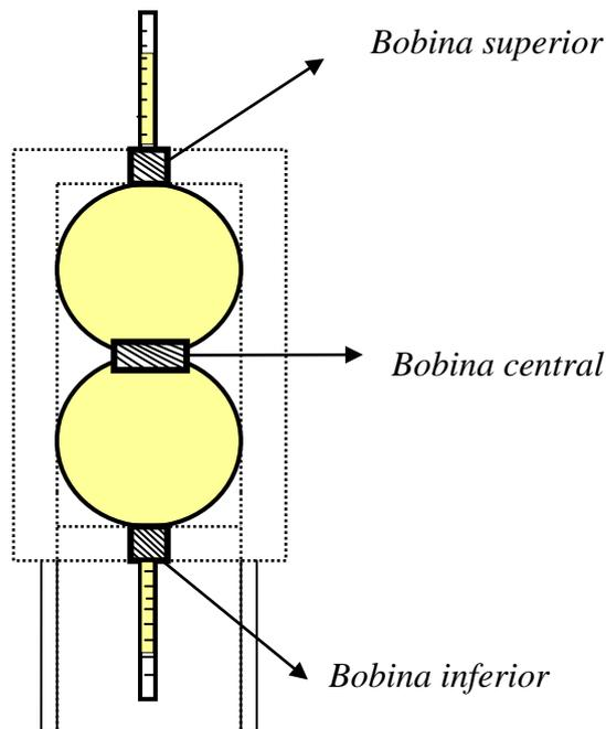
**Fig. 06** – Posição dos balões na caixa hermética.
