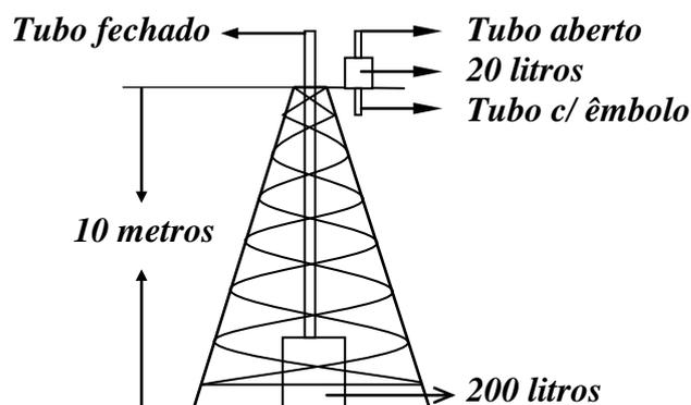
**Fig. 15** – Torre, tubo e tanque.
